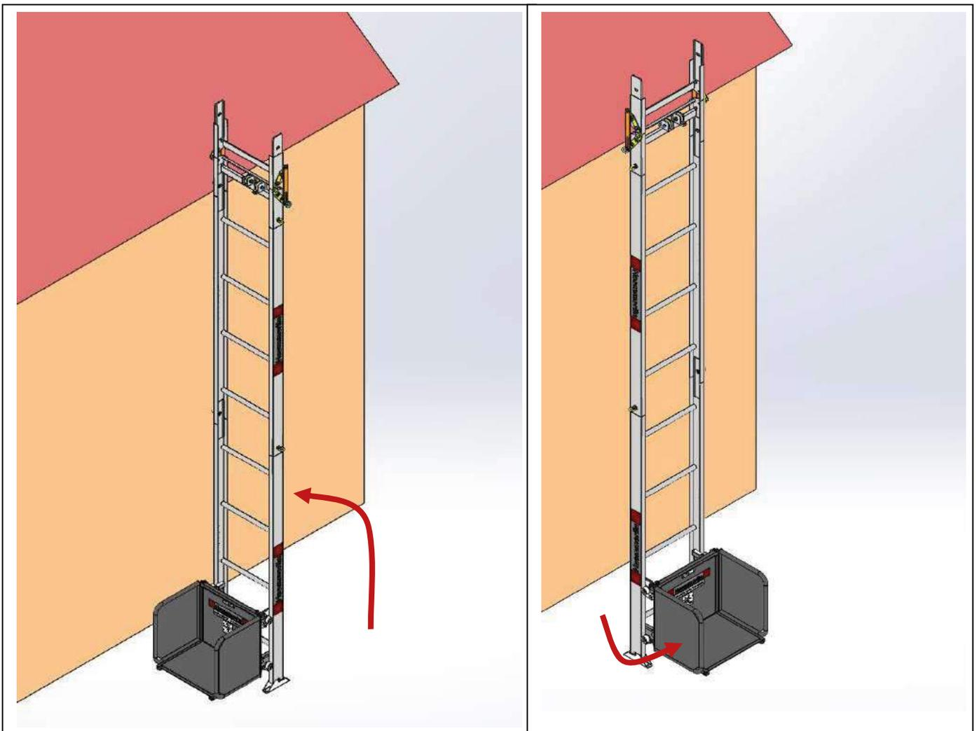
Régler la genouillère à l'angle du toit (minimum d'inclinaison 30° par rapport au sol). Pour plier la genouillère, desserrer les écrous à anse, régler l'angle d'inclinaison souhaité (au minimum 30° par rapport à l'horizontale), puis resserrer les écrous à anse.
