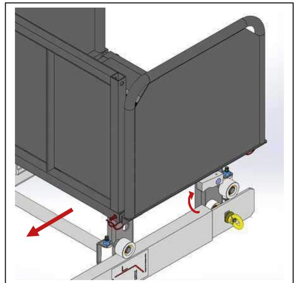
Assembler les échelles, les verrouiller au moyen de boulons rapides et si nécessaire, ajouter une genouillère en position ouverte et la verrouiller. L'assemblage au sol peut se faire parallèlement ou perpendiculairement à la façade selon la place disponible.
