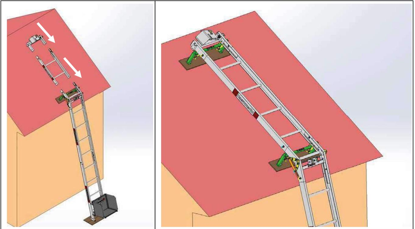
En cas de toit plat ou en intérieur de bâtiment, la traverse de tête peut s'appuyer directement sur le toit plat ou la dalle intérieure en mettant en place une paire d'étais de traverse de tête (voir paragraphe « étaiyages »).
