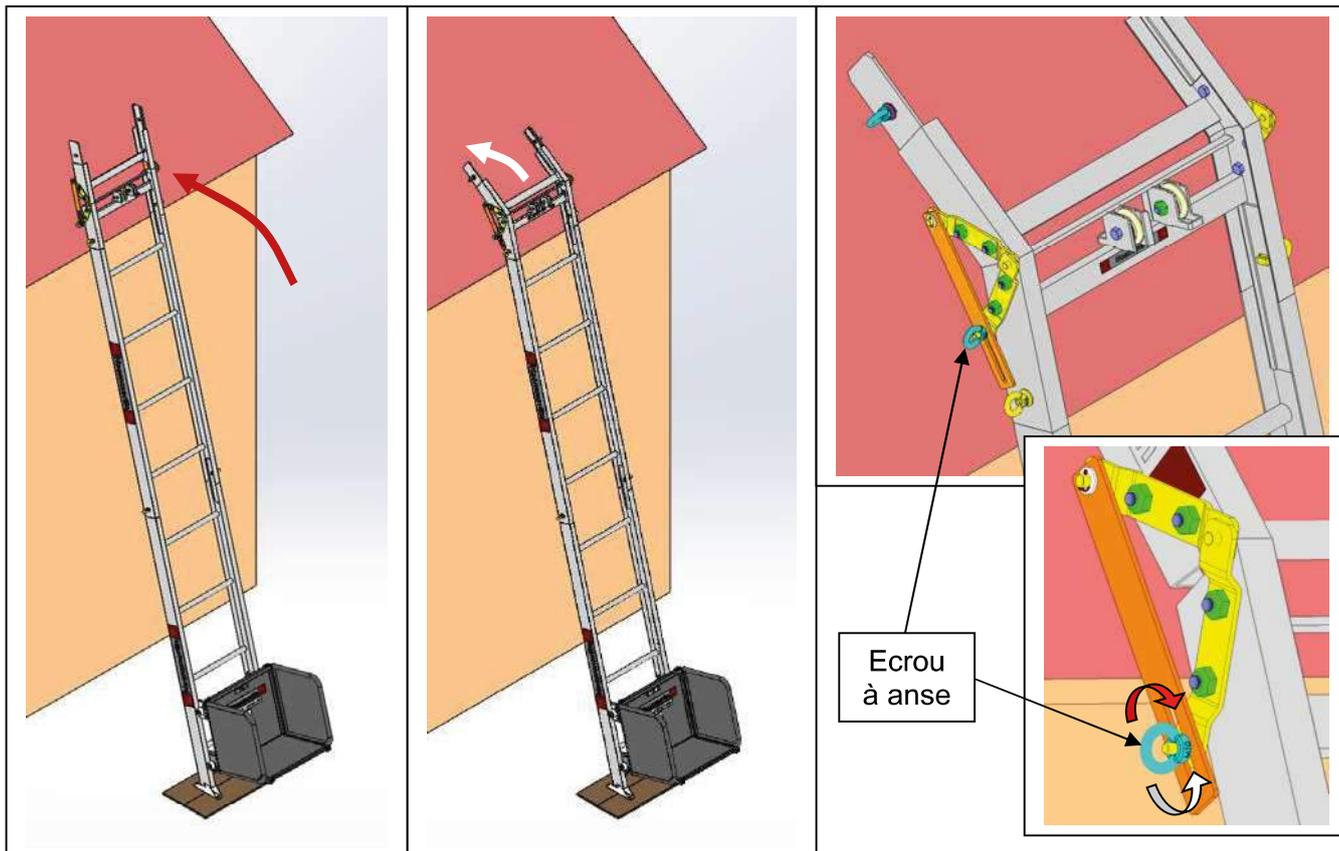
La genouillère peut s'appuyer directement sur le toit ou sur des tréteaux. Elle doit toujours être en appui, soit directement sur le bâtiment, soit par l'intermédiaire d'un tréteau. Le tréteau peut s'appuyer directement sur le toit ou sur une planche pour une meilleure répartition des efforts.
