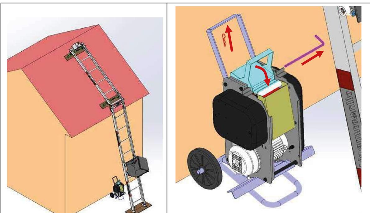
Déposer la traverse basse du treuil sur l'échelon inférieur de l'échelle de base, puis encastrer entièrement le treuil en agissant sur la poignée arrière. Dès que le treuil est entièrement encastré, relever la poignée de verrouillage pour bloquer le treuil, puis insérer l'axe de verrouillage et la goupille de sécurité. Le treuil est prêt à être branché.
