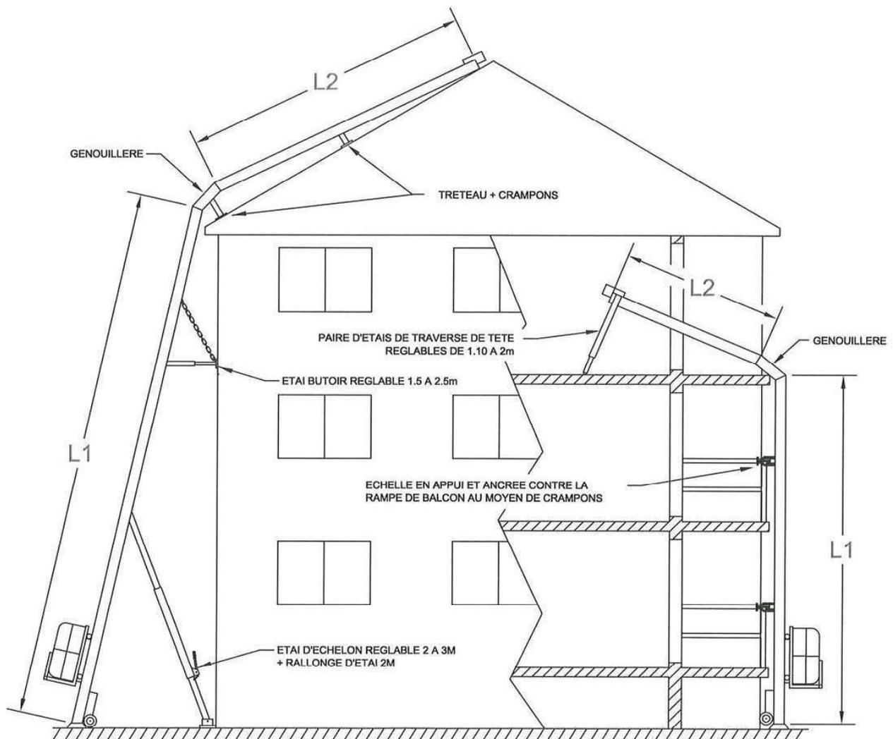
A la verticale, ancrer l'échelle au bâtiment au moyen des serre-joints d'embrasure et de balcon ou contre l'échafaudage au moyen de tubes et crampons, à chaque étage.
