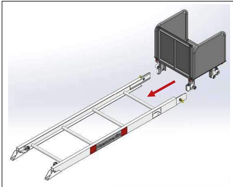
Pour pouvoir engager entièrement le chariot dans l'échelle, il faut déverrouiller les cames du parachute en tournant son axe. Le chariot doit être orienté de façon que les cames du parachute soient en haut quand l'échelle est relevée.
