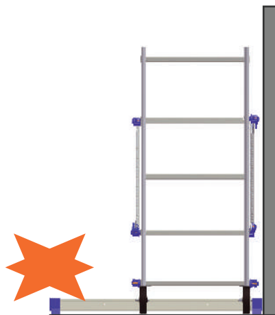
BARRES STABILISATRICES COULISSANTES travail contre un mur
