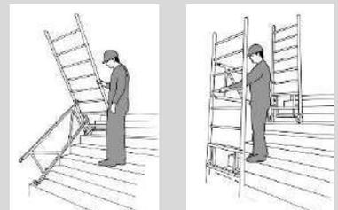
Schéma : Verrouillage des crochets bascules
