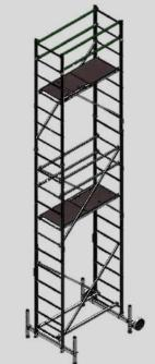
7 Monter sur le plateau toujours par l'intérieur en passant par la trappe qui ne doit pas rester ouverte.
