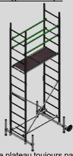
**4** Monter sur le plateau toujours par l'intérieur en passant par la trappe qui ne doit pas rester ouverte.
