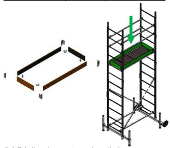
**5.1** Réaliser le montage des plinthes Utiliser les 4 équerres positionner au 4 coins et réaliser la fixation avec les 16x vis M8x25, 16x écrous M8 et 16x rondelle M8.
