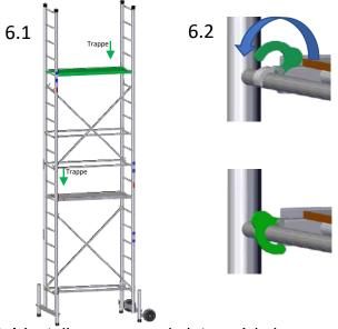
**6-1** Installer un second plateau à la bonne hauteur pour le travail : en gardant toujours un minimum de 3 échelons au-dessus de ce dernier afin d'installer les garde-corps. La trappe doit se trouver du côté opposé de la trappe du plateau inférieur.
