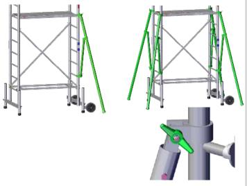
**3** L'installation de stabilisateurs est obligatoire à partir de 4 m plancher (2 stab.) et 5 m plancher (4 stab.)
