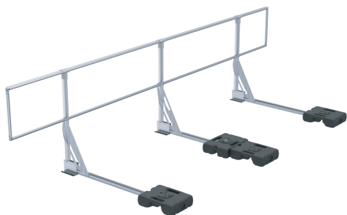
REF : 102398 Kit garde-corps autoportant rabattable de 4,5 ml. Livré avec 4 plots lestés de 25kg avec enveloppe PEHD.
