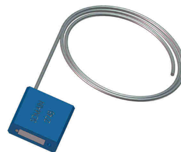
REF : 100124 Plombage. Se fixe sur le tendeur de façon à empêcher une modification de la tension du câble. Traçabilité par numéro de série unique.
