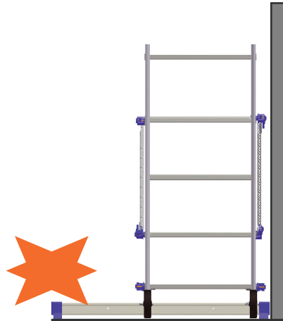
DOPPELTE VERSTELLUNG DER TRAVERSE um näher an die Wand heranzukommen
