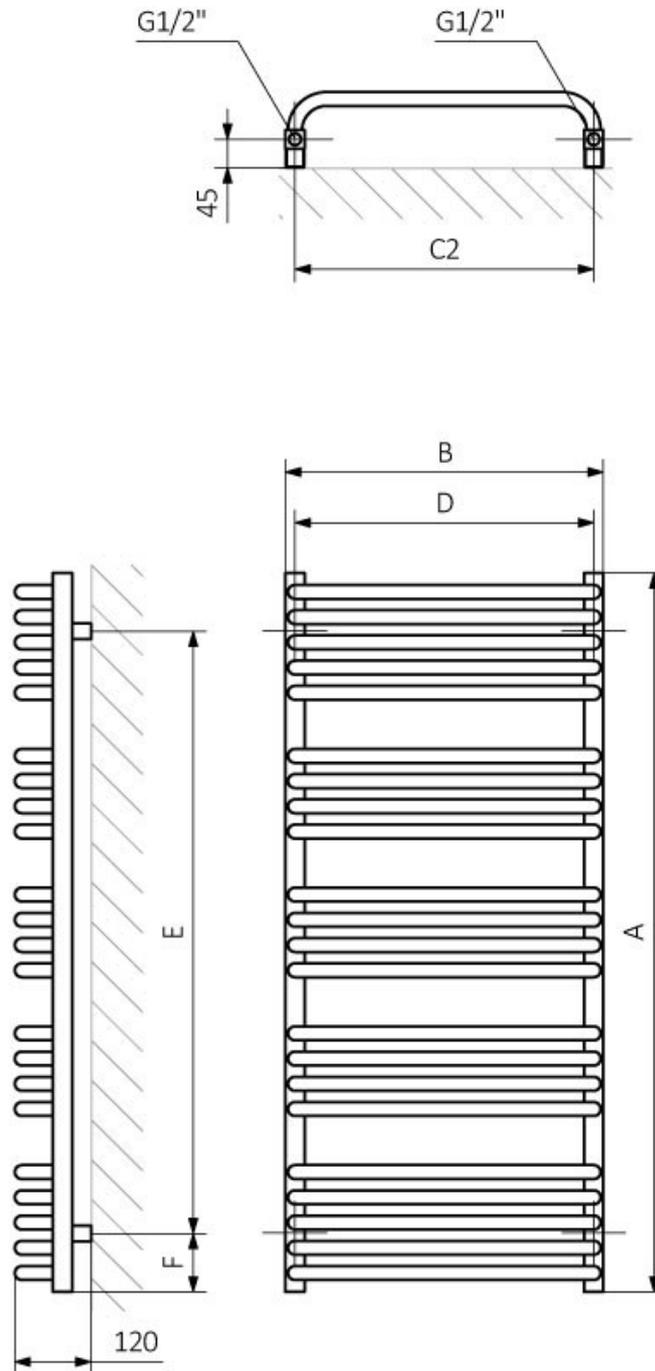
A – Höhe B – Breite C1-C5 – Abstand zwischen den Anschlüssen D – horizontaler Abstand zwischen den Befestigungen E – vertikaler Abstand zwischen den Geräten
