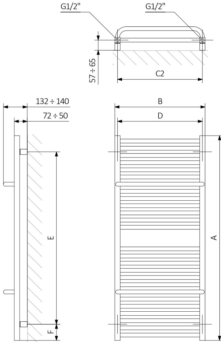
A – Höhe B – Breite C1-C5 – Abstand zwischen den Anschlüssen D – horizontaler Abstand zwischen den Befestigungen E – vertikaler Abstand zwischen den Geräten
