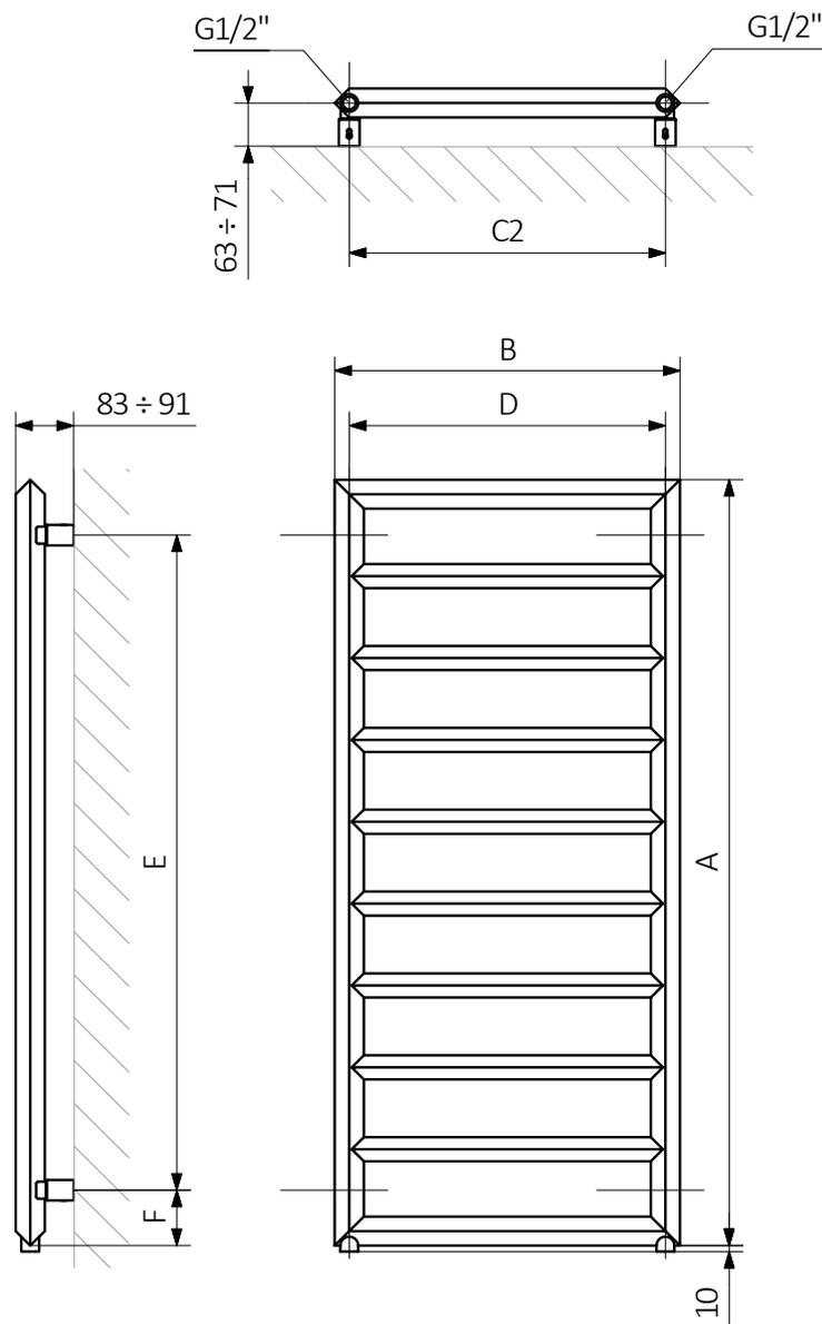
A – Höhe B – Breite C1-C5 – Abstand zwischen den Anschlüssen D – horizontaler Abstand zwischen den Befestigungen E – vertikaler Abstand zwischen den Geräten
