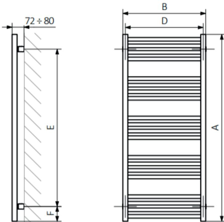
A – Höhe B – Breite C1-C5 – Abstand zwischen den Anschlüssen D – horizontaler Abstand zwischen den Befestigungen E – vertikaler Abstand zwischen den Geräten
