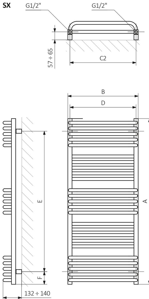
A – Höhe B – Breite C1-C5 – Abstand zwischen den Anschlüssen D – horizontaler Abstand zwischen den Befestigungen E – vertikaler Abstand zwischen den Geräten
