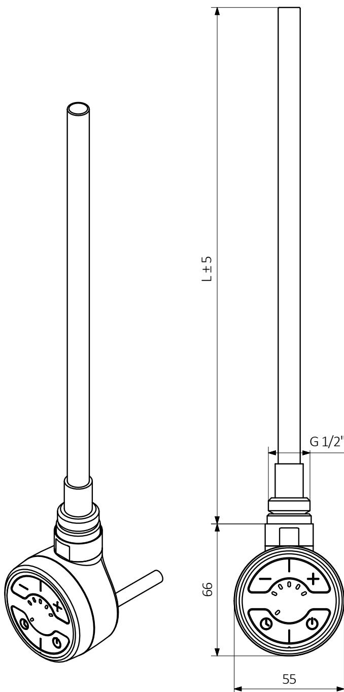
Gerades Kabel ohne Stecker mit Kabelabdeckung
