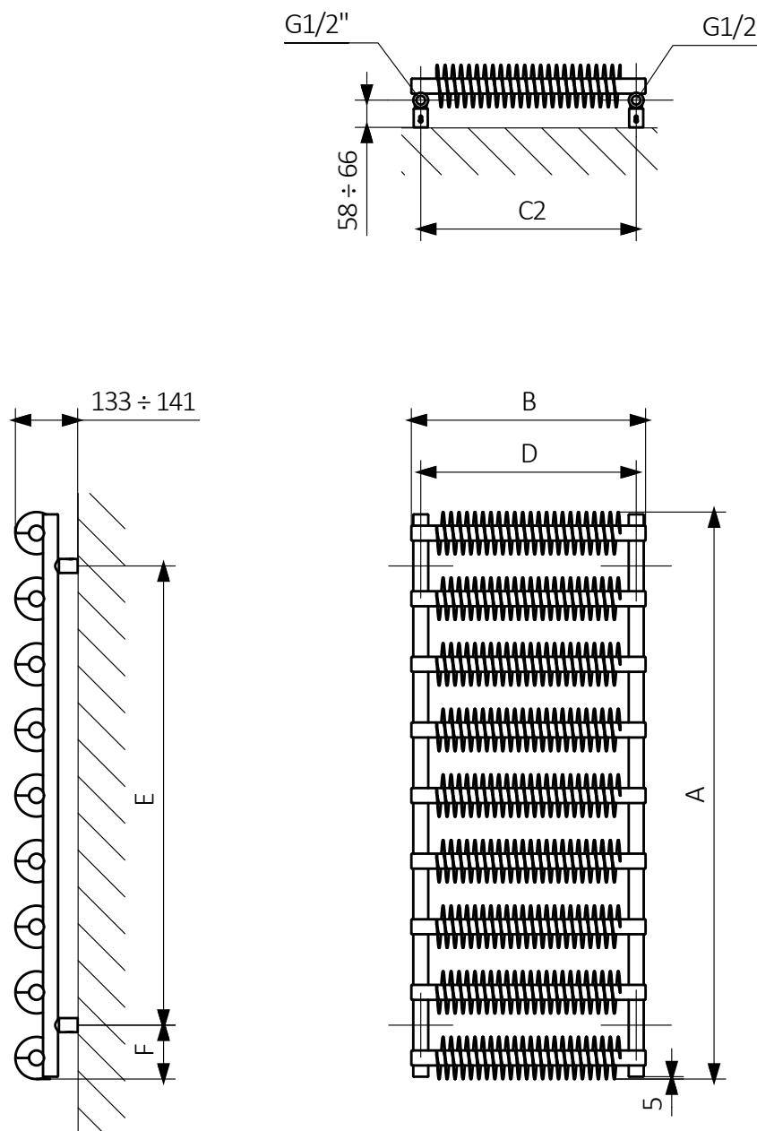
A – Höhe B – Breite C1-C5 – Abstand zwischen den Anschlüssen D – horizontaler Abstand zwischen den Befestigungen E – vertikaler Abstand zwischen den Geräten
