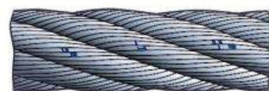
fils cassés au niveau des "parures"
