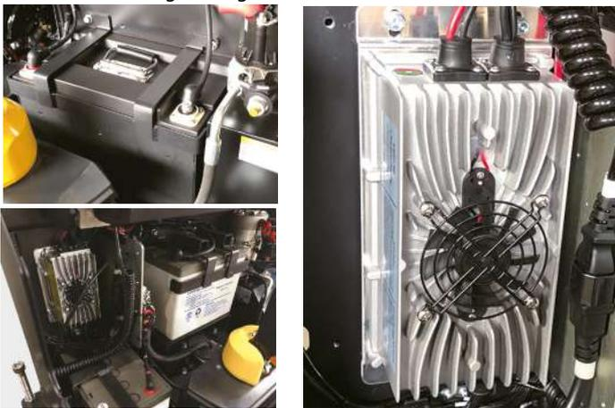
Der Gabelstapler PSE12N ist mit einer wartungsfreien 24 V / 60 Ah Li-Ion LifePO4-Batterie mit Schnellladung und einer sehr hohen Anzahl von Lade-/Entladezyklen während der Lebensdauer ausgestattet.
