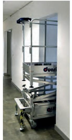
Largeur 0,75 m permettant le passage des portes de 0,83 m.
