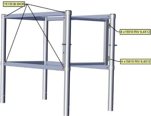
5 : Das Geländer wird montiert und dann an der Baugruppe angebracht.
