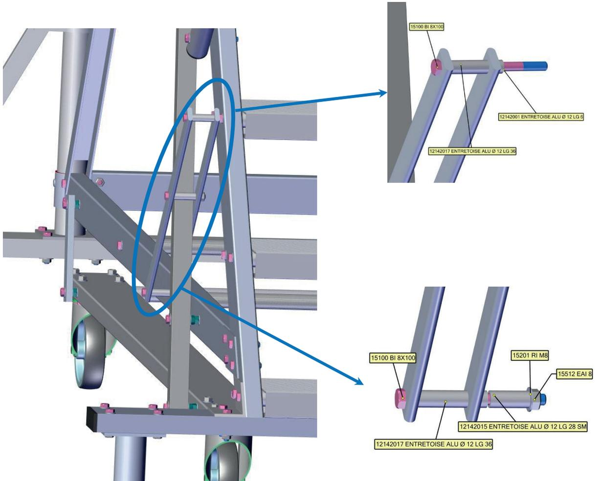
Oberer Teil der Hebelführung: die vorhandene Schraube durch die mit dem KRE gelieferte 8x100-Schraube Ersetzen und dann die oben beschriebene Montagereihenfolge befolgen.
