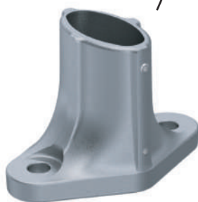
Art-Nr : 100253 Sockel zur flachen Befestigung. Befestigung: 2 M12 Achsabstand: 100 mm
