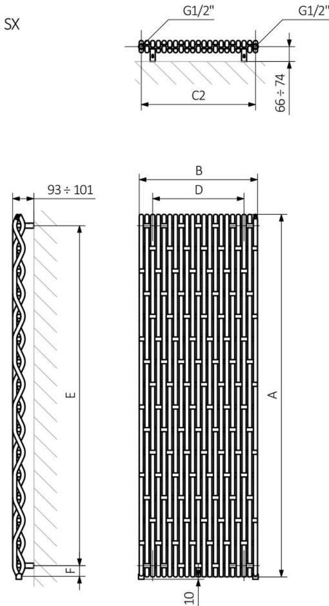
A – Hauteur B – Largeur C1-C5 – espacement des connexions D – espacement horizontal des attaches E – espacement vertical des attaches F – distance de l'axe inférieur des attaches au bord inférieur du collecteur
