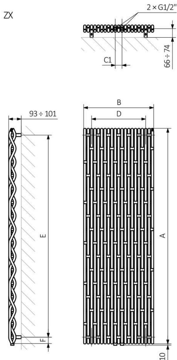
A – Hauteur B – Largeur C1-C5 – espacement des connexions D – espacement horizontal des attaches E – espacement vertical des attaches F – distance de l'axe inférieur des attaches au bord inférieur du collecteur
