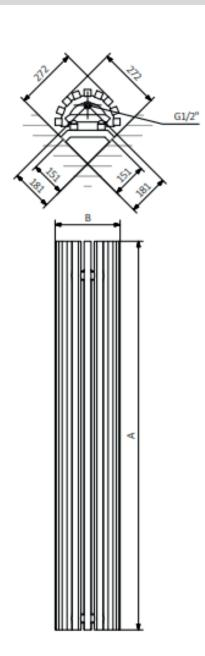
A – hauteur B – largeur C1-C5 – écartement des raccordements D – écartement des consoles en horizontal E – écartement des consoles en vertical F – distance de l'axe de la console inférieure au bord inférieur du collecteur
