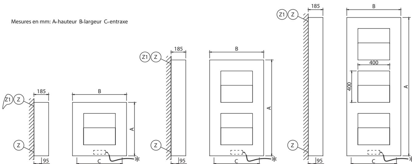
\*Interrupteur pour corps éclairant comprenant un câble d'1 m doté de prise
