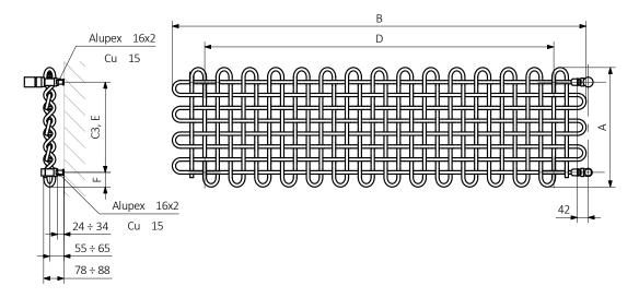
A – hauteur B – largeur C1-C5 – écartement des raccordements D – écartement des consoles en horizontal E — écartement des consoles en vertical F – distance de l'axe de la console inférieure au bord inférieur du collecteur
