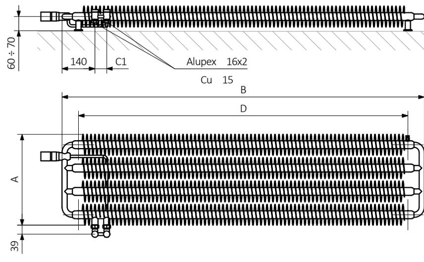
A – hauteur B – largeur C1-C5 – écartement des raccords D – écartement des consoles en horizontal E – écartement des consoles en vertical F – distance de l'axe de la console inférieure au bord inférieur du collecteur
