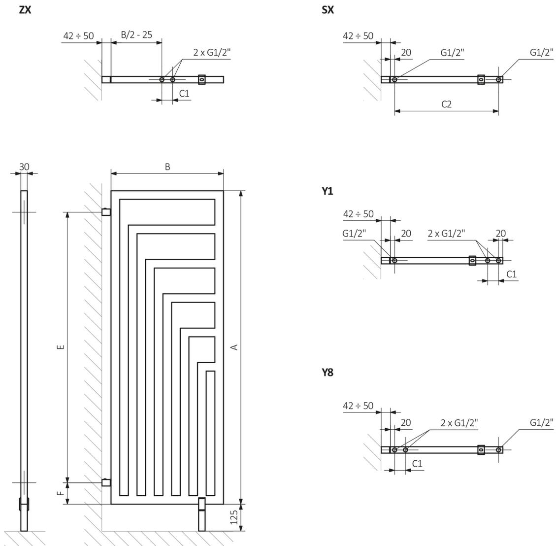
A - Hauteur / B - Largeur / C1-C5 - Ecartement des raccords / D - Ecartement des consoles en horizontal / E - Ecartement des consoles en vertical / F - Distance de l'axe de la console inférieure au bord inférieur du collecteur
