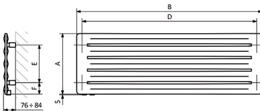
A – hauteur B – largeur C1-C5 – écartement des raccords D – écartement des consoles en horizontal E – écartement des consoles en vertical F – distance de l'axe de la console inférieure au bord inférieur du collecteur
