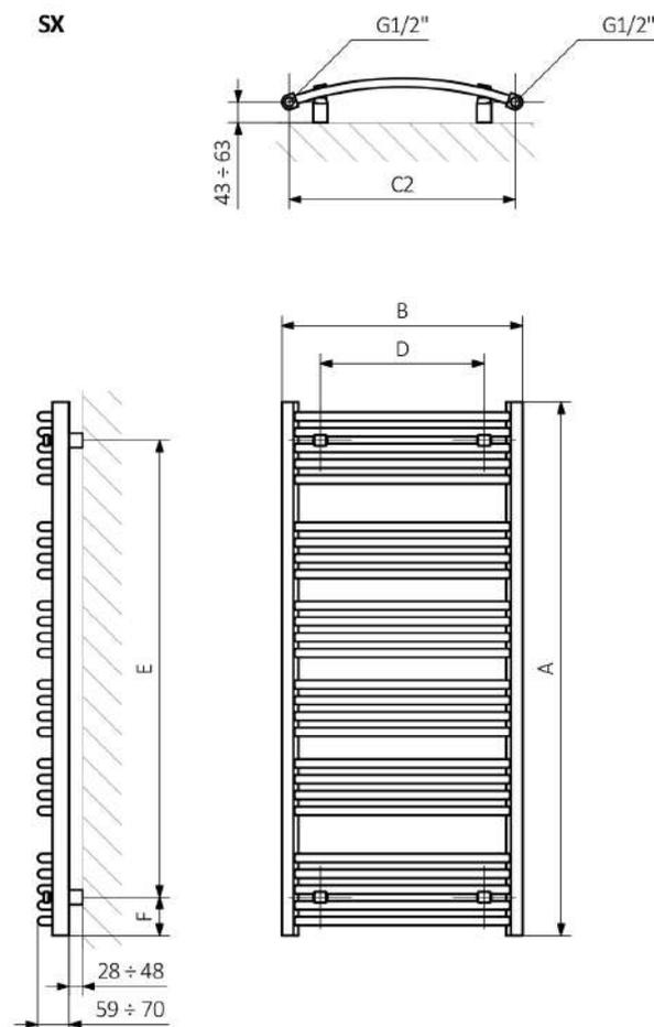
A - Altezza / B - Larghezza / C1-C5 - Distanza tra i raccordi / D - Interasse tra i tubi verticali / E - Distanza tra i punti di fissaggio / F - Distanza dell'asse del punto di fissaggio inferiore al bordo inferiore dello scaldasalviette
