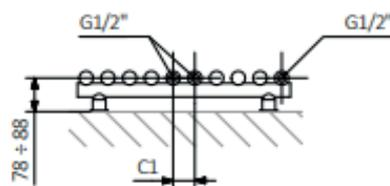
A - Altezza / B - Larghezza / C1-C5 - Distanza tra i raccordi / D - Interasse tra i tubi verticali / E - Distanza tra i punti di fissaggio / F - Distanza dell'asse del punto di fissaggio inferiore al bordo inferiore dello scaldasalviette
