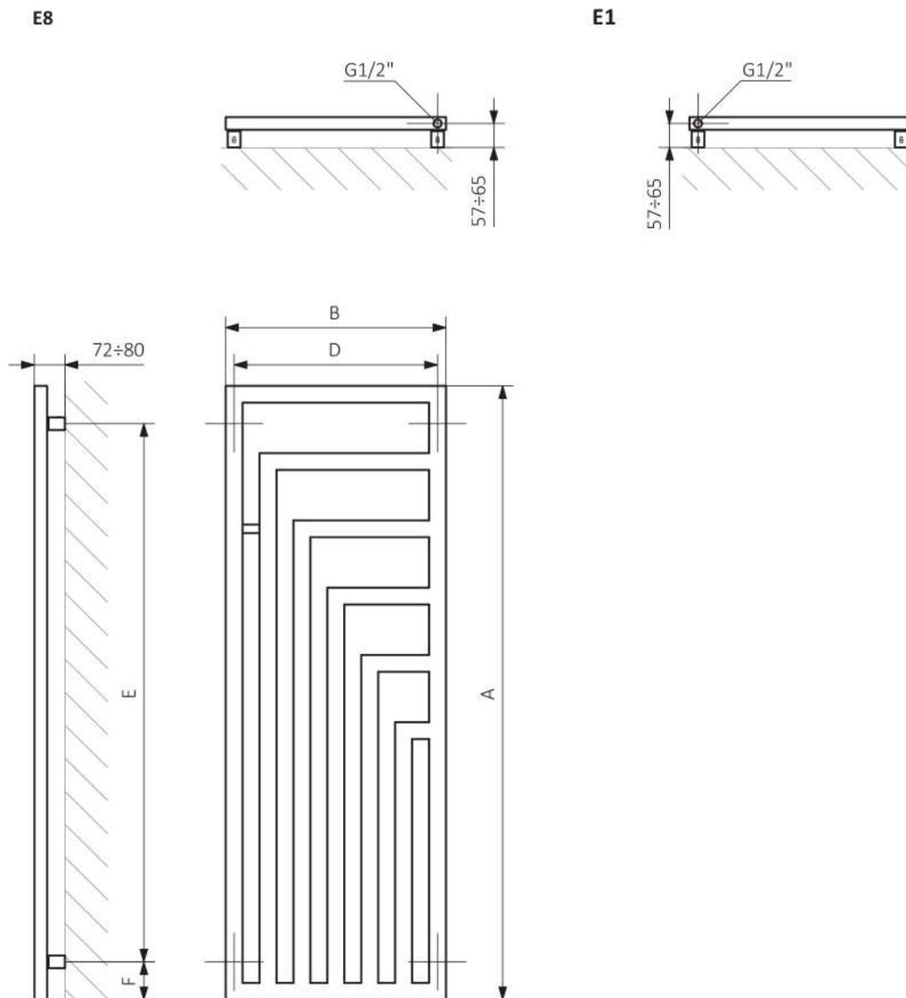
A - altezza B - larghezza C1-C5 - distanza tra i raccordi D - distanza tra le console in orizzontale E - distanza tra le console in verticale F - distanza tra l'asse inferiore dei fissaggi e il bordo inferiore del collettore
