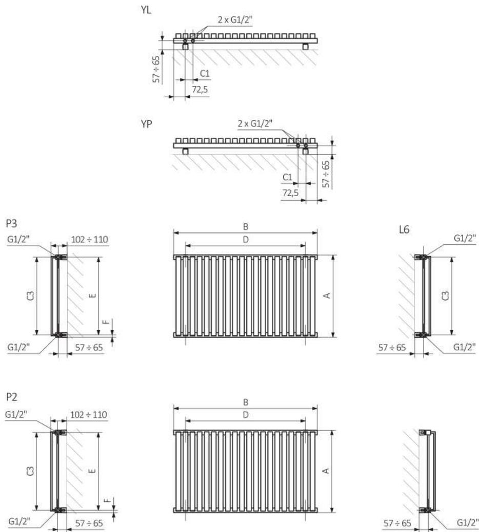
A - altezza B - larghezza C1-C5 - distanza tra i collegamenti D - distanza orizzontale tra i fissaggi E - distanza verticale tra i dispositivi F - distanza tra l'asse inferiore dei fissaggi e il bordo inferiore del collettore
