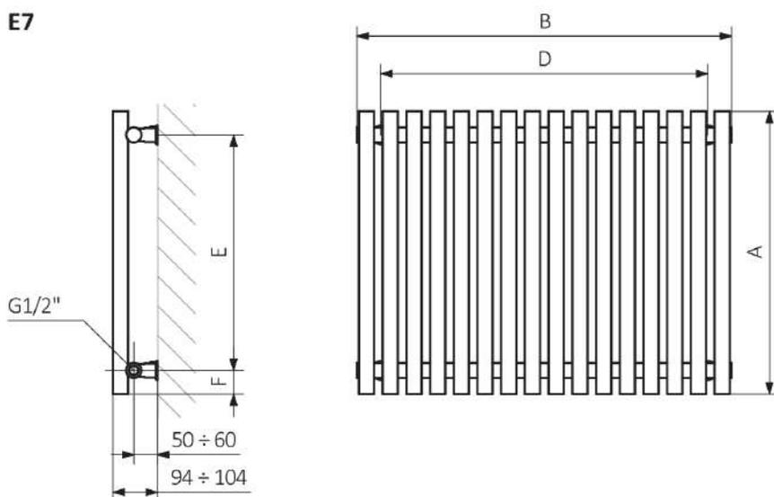
A - altezza B - larghezza C1-C5 - distanza tra i collegamenti D - distanza orizzontale tra i fissaggi E - distanza verticale tra i dispositivi F - distanza tra l'asse inferiore dei fissaggi e il bordo inferiore del collettore
