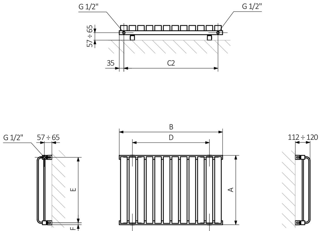
A - altezza B - larghezza C1-C5 - distanza tra i raccordi D - distanza tra le console in orizzontale E - distanza tra le console in verticale F - distanza tra l'asse inferiore dei fissaggi e il bordo inferiore del collettore
