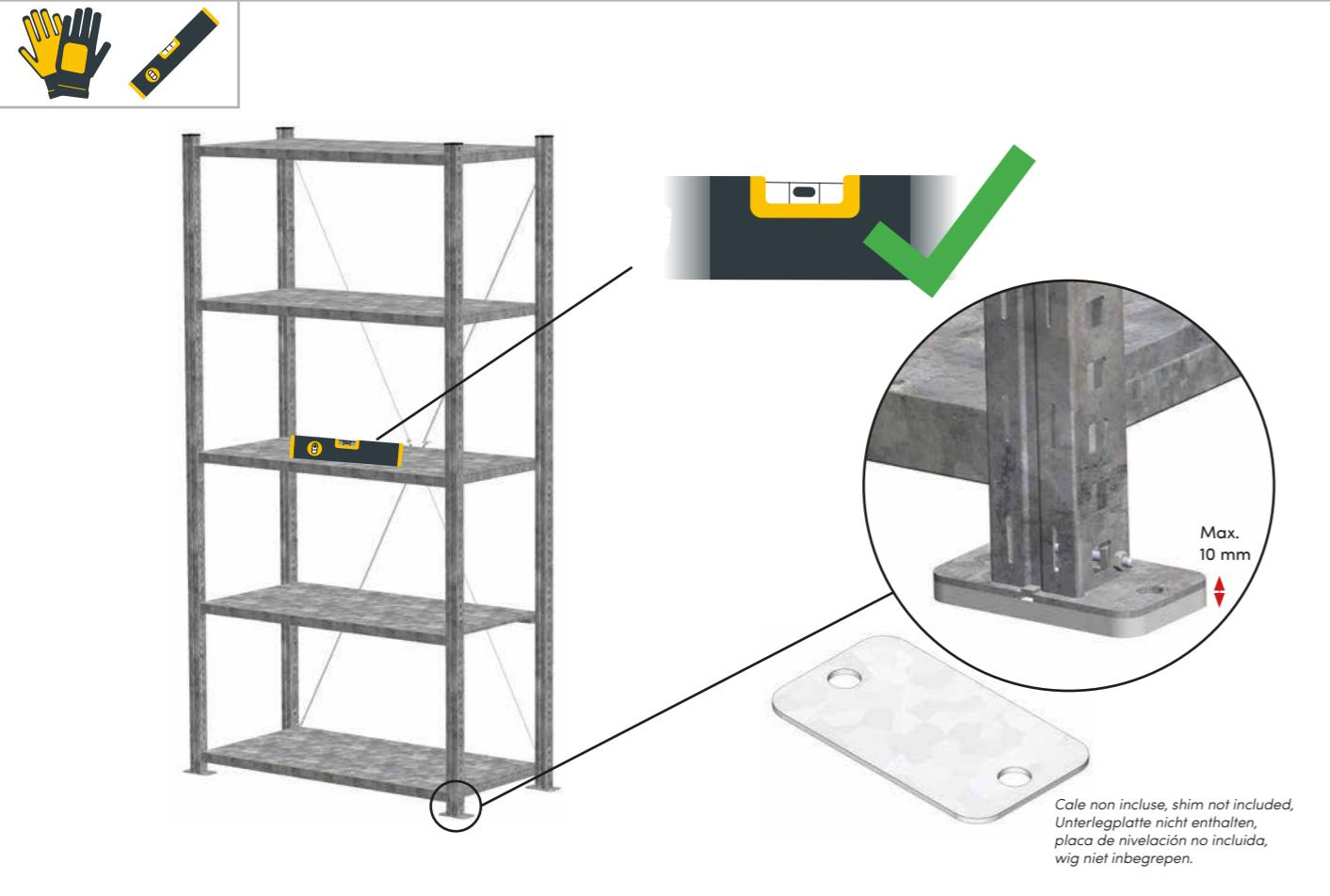
5 - Assemblage des éléments suivants / Assembling the extension bays / Montage der Anbauelemente /
