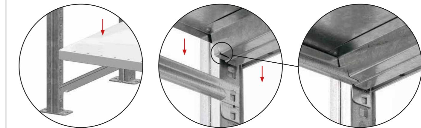
Mise en place de la tablette suivante / Installing the next shelf / Montage des folgenden Fachböden /
