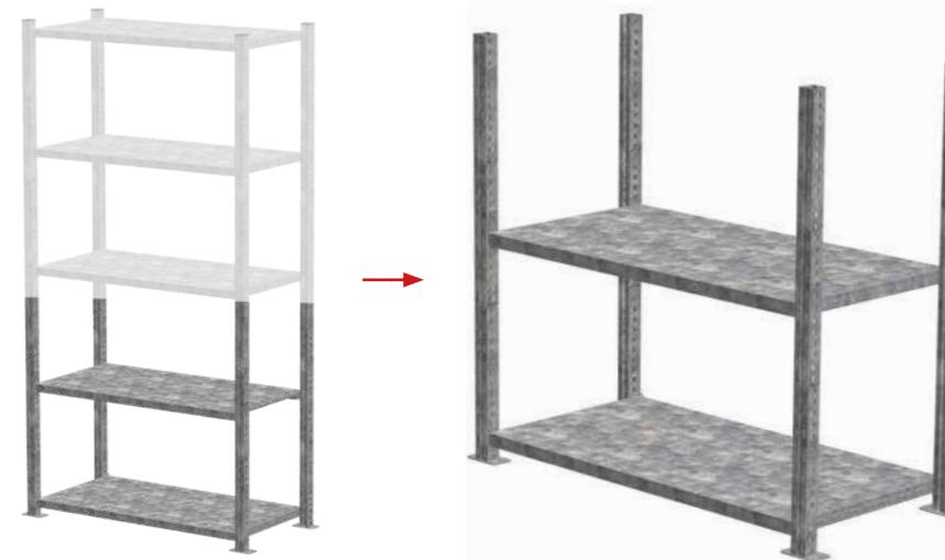
1.1 Mise en place des platines / Positioning the footplates / Montage der Fußplatten /
