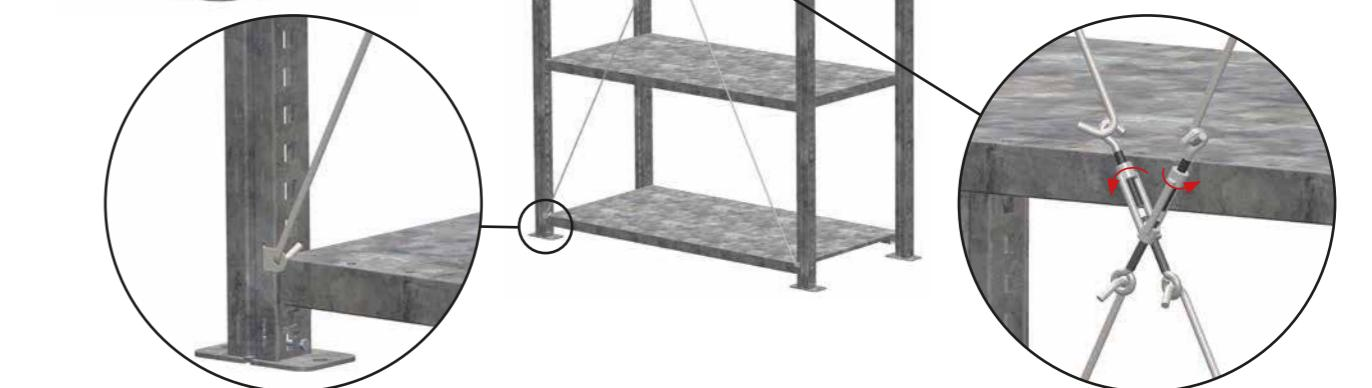
4 - Réglage des niveaux / Level adjustment / Verstellung der Ebenen / Ajuste de los niveles / Afstelling van de niveaus
