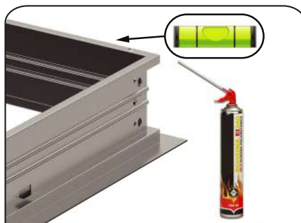
2.4 Assicurarsi che il nervo-telaio sia in bolla! Utilizzare schiuma poliuretantica.
