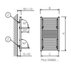
Radiator body dimensions Größe des Heizkörpers Dimensions du corps chauffant Dimensiones del cuerpo calefactor
