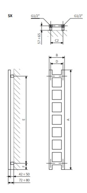
A - Altezza B - larghezza C1-C5 - distanza tra i raccordi D - distanza tra gli assi in orizzontale E - distanza tra gli assi in verticale F - distanza dell'asse inferiore al bordo inferiore del collettore
