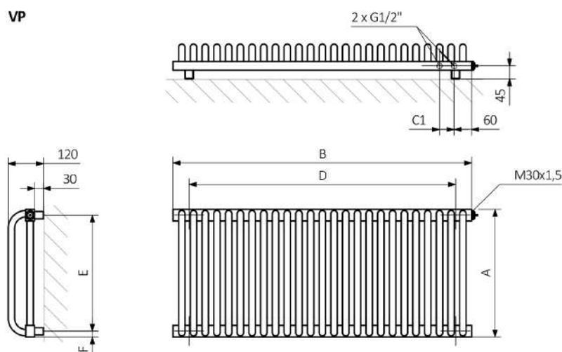
A - Altezza / B - Larghezza / C1-C5 - Distanza tra i raccordi / D - Interasse tra i tubi verticali / E - Distanza tra i punti di fissaggio / F - Distanza dell'asse del punto di fissaggio inferiore al bordo inferiore dello scaldasalviette
