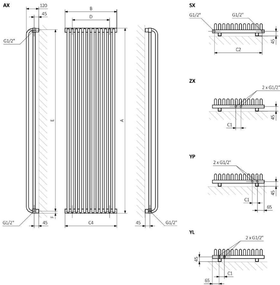
A - Altezza / B - Larghezza / C1-C5 - Distanza tra i raccordi / D - Interasse tra i tubi verticali / E - Distanza tra i punti di fissaggio / F - Distanza dell'asse del punto di fissaggio inferiore al bordo inferiore dello scaldasalviette
