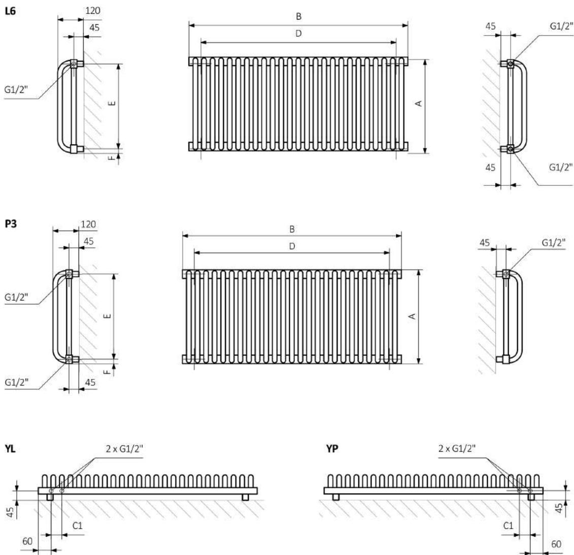
A - Altezza / B - Larghezza / C1-C5 - Distanza tra i raccordi / D - Interasse tra i tubi verticali / E - Distanza tra i punti di fissaggio / F - Distanza dell'asse del punto di fissaggio inferiore al bordo inferiore dello scaldasalviette
