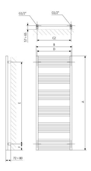
A - Altezza / B - Larghezza / C1-C5 - Distanza tra i raccordi / D - Interasse tra i tubi vercitali / E - Distanza tra i punti di fissaggio / F - Distanza dell'asse del punto di fissaggio inferiore al bordo inferiore dello scaldasalviette
