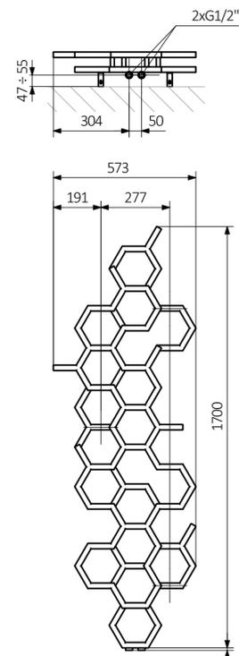
A - Altezza / B - Larghezza / C1-C5 - Distanza tra i raccordi / D - Interasse tra i tubi verticali / E - Distanza tra i punti di fissaggio / F - Distanza dell'asse del punto di fissaggio inferiore al bordo inferiore dello scaldasalviette
