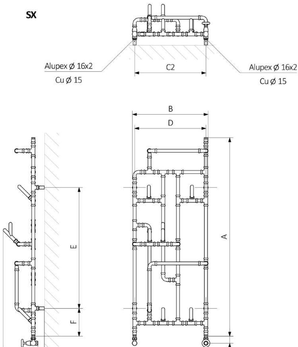
A - Altezza / B - Larghezza / C1-C5 - Distanza tra i raccordi / D - Interasse tra i tubi verticali / E - Distanza tra i punti di fissaggio / F - Distanza dell'asse del punto di fissaggio inferiore al bordo inferiore dello scaldasalviette
