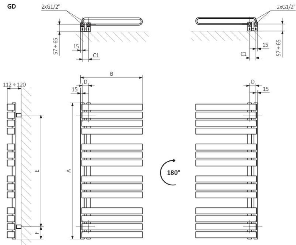
A - Altezza / B - Larghezza / C1-C5 - Distanza tra i raccordi / D - Interasse tra i tubi verticali / E - Distanza tra i punti di fissaggio / F - Distanza dell'asse del punto di fissaggio inferiore al bordo inferiore dello scaldasalviette
