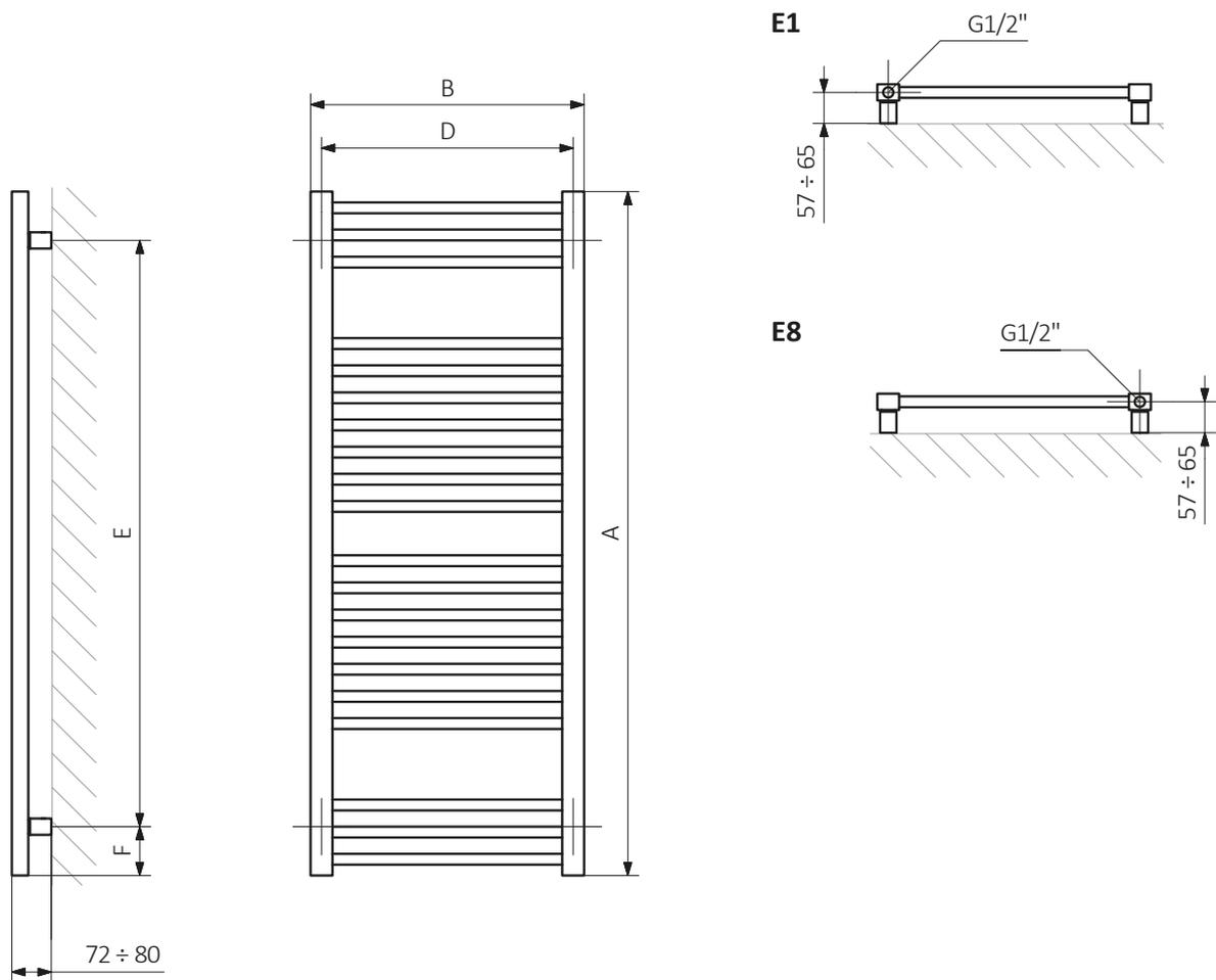
A - altezza B - larghezza C1-C5 - distanza tra i collegamenti D - distanza orizzontale tra i fissaggi E - distanza verticale tra i dispositivi F - distanza tra l'asse inferiore dei fissaggi e il bordo inferiore del collettore
