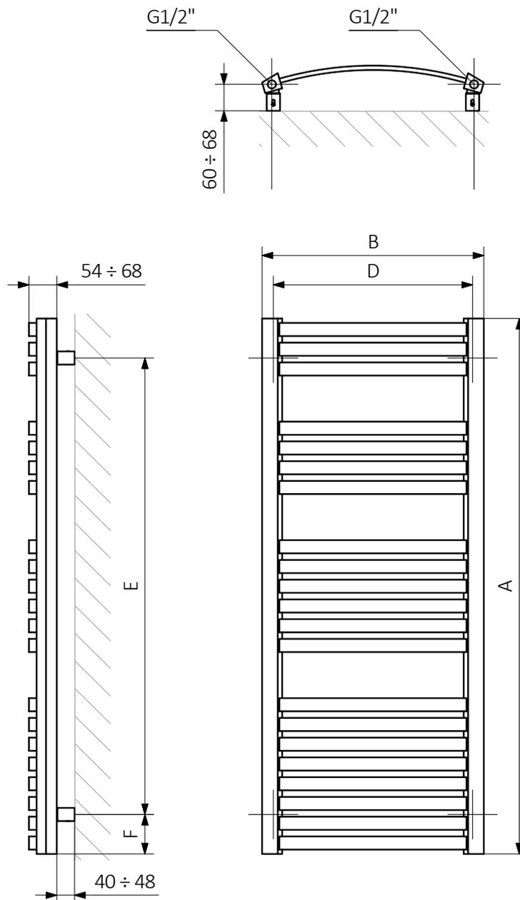
A - altezza B - larghezza C1-C5 - distanza tra i collegamenti D - distanza orizzontale tra i fissaggi E - distanza verticale tra i dispositivi F - distanza tra l'asse inferiore dei fissaggi e il bordo inferiore del collettore
