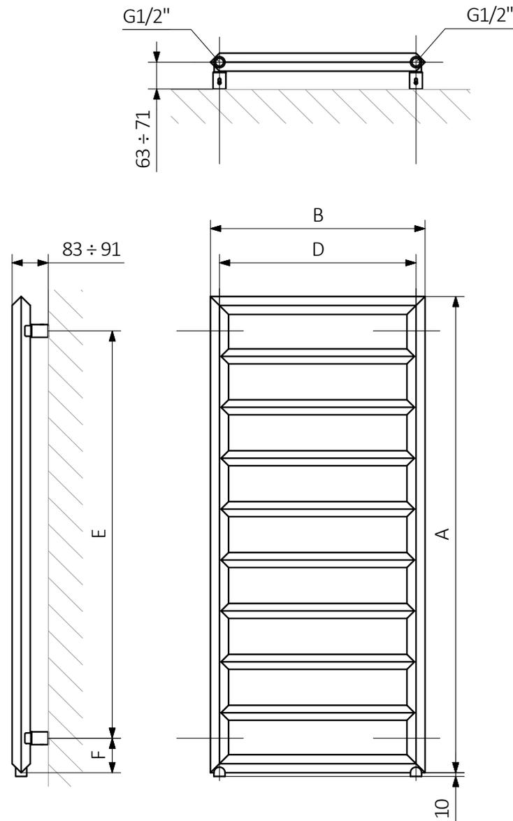
A - altezza B - larghezza C1-C5 - distanza tra i collegamenti D - distanza orizzontale tra i fissaggi E - distanza verticale tra i dispositivi F - distanza tra l'asse inferiore dei fissaggi e il bordo inferiore del collettore
