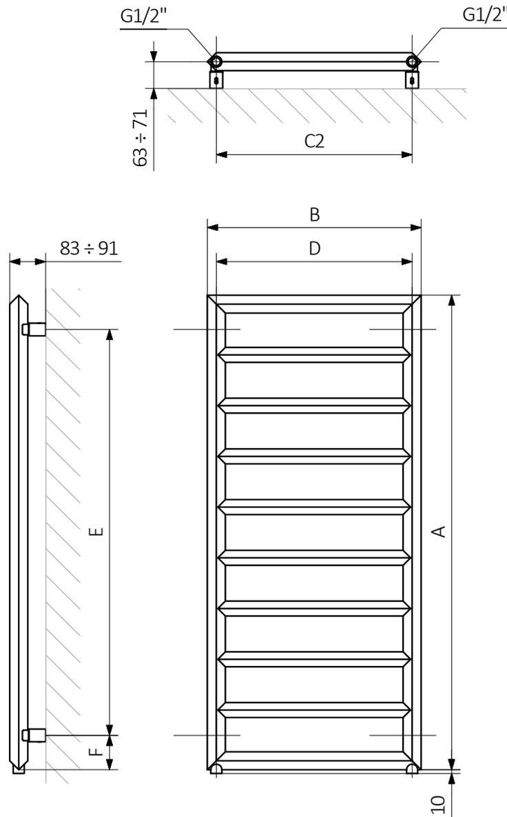
A - altezza B - larghezza C1-C5 - distanza tra i collegamenti D - distanza orizzontale tra i fissaggi E - distanza verticale tra i dispositivi F - distanza tra l'asse inferiore dei fissaggi e il bordo inferiore del collettore
