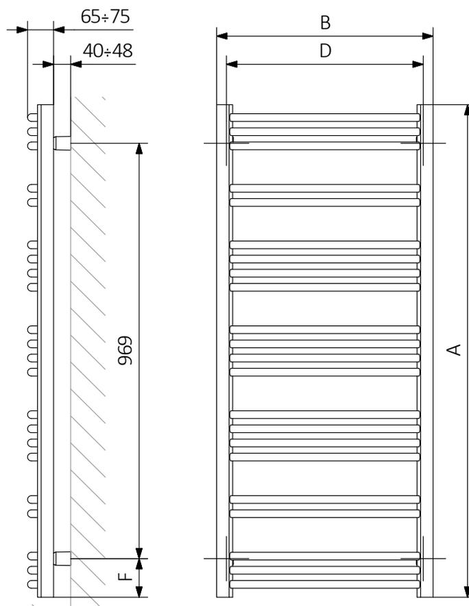
A - altezza B - larghezza C1-C5 - distanza tra i collegamenti D - distanza orizzontale tra i fissaggi E - distanza verticale tra i dispositivi F - distanza tra l'asse inferiore dei fissaggi e il bordo inferiore del collettore
