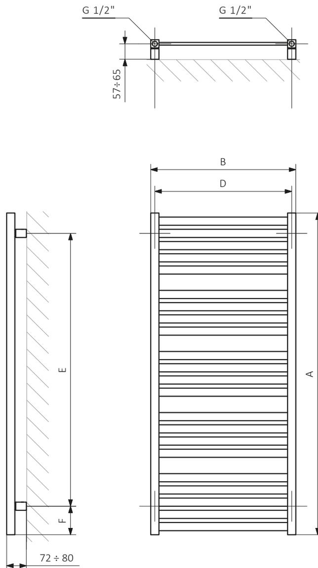
A - altezza B - larghezza C1-C5 - distanza tra i collegamenti D - distanza orizzontale tra i fissaggi E - distanza verticale tra i dispositivi F - distanza tra l'asse inferiore dei fissaggi e il bordo inferiore del collettore
