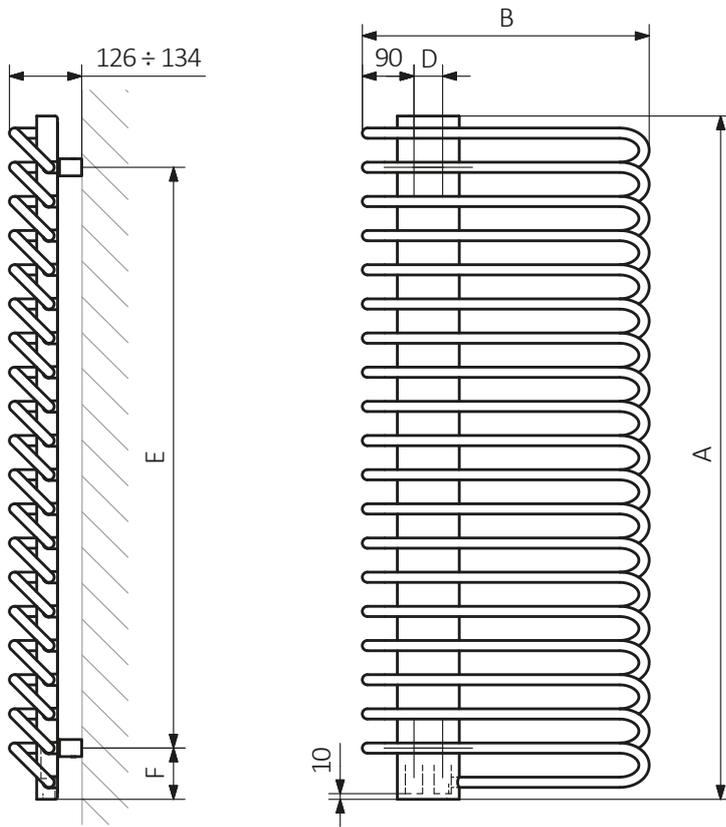
A - hauteur B - largeur C1-C5 - espacement des connexions D - distance entre les fixations à l'horizontale E - distance entre les dispositifs en F verticale - distance entre l'axe inférieur des fixations et le bord inférieur du collecteur
