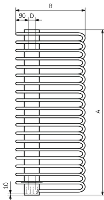
A - Altezza B - Larghezza C1-C5 - Distanza tra connessioni D - Distanza orizzontale tra gli elementi di fissaggio
