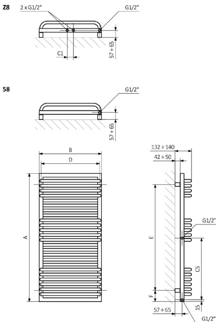
A - Altezza B - Larghezza C1-C5 - Distanza tra connessioni D - Distanza orizzontale tra gli elementi di fissaggio E - Distanza verticale tra gli elementi di fissaggio F - Distanza dall'asse centrale inferiore degli elementi di fissaggio al bordo inferiore del collettore
