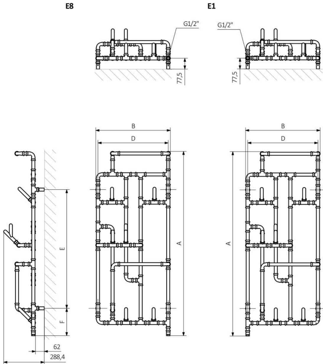
A - Altezza B - Larghezza C1-C5 - Interasse dei collegamenti D - Distanza tra i fissaggi in orizzontale E - Distanza tra i fissaggi in verticale F - Distanza tra l'asse inferiore dei fissaggi e il bordo inferiore del collettore
