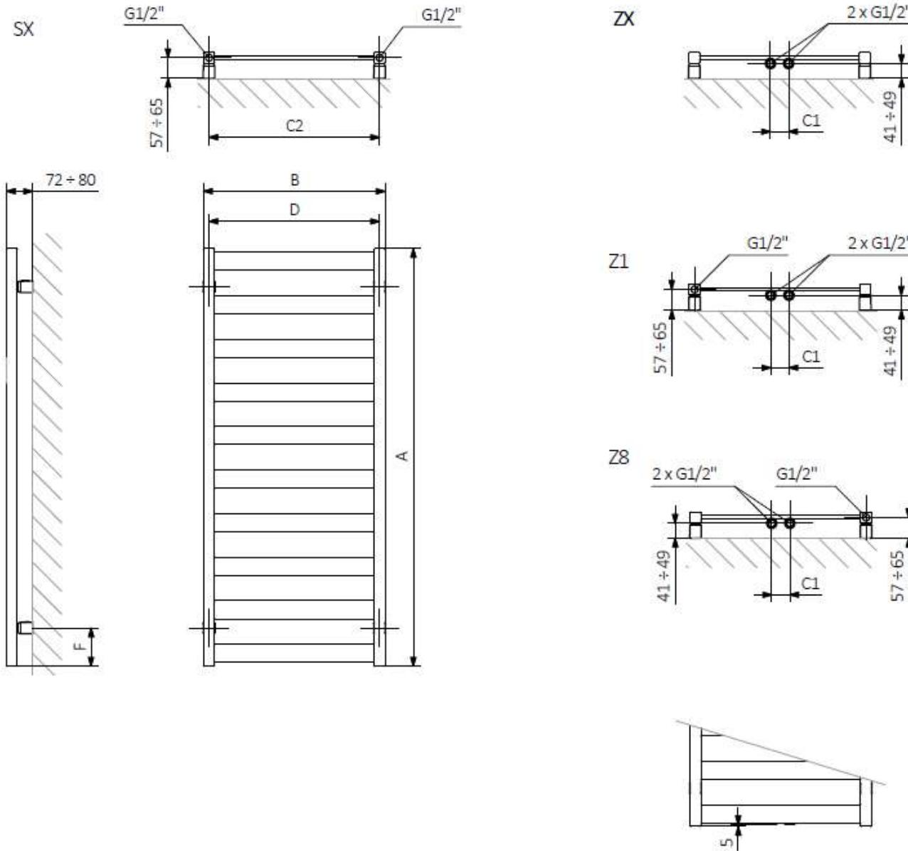
A - altezza B - larghezza C1-C5 - spaziatura delle connessioni D - distanza orizzontale tra i fissaggi E - distanza verticale tra i dispositivi F - distanza tra il centro dei fissaggi inferiori e il bordo inferiore del collettore
